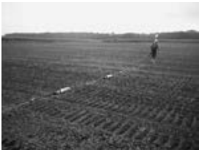
写真-3 けん引式電気探査 (オームマップター)
