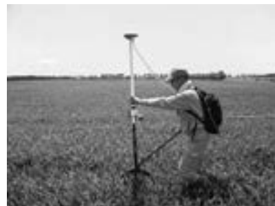
写真-5 位置情報の取得 (VRS方式 RTK-GPS)
